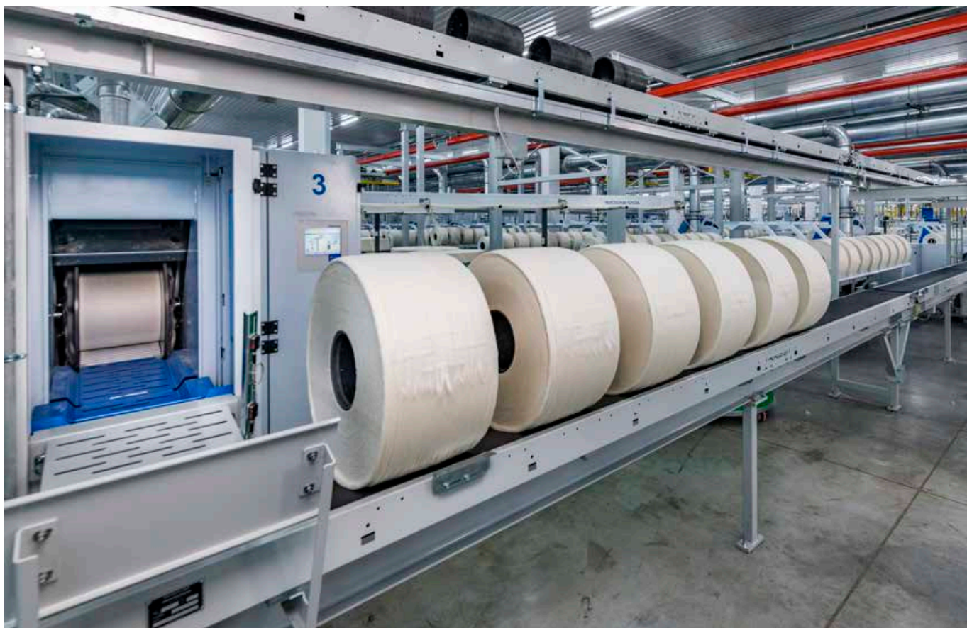
图片中为用于棉卷运输自动装置的棉卷运输单元 (LTS)。
