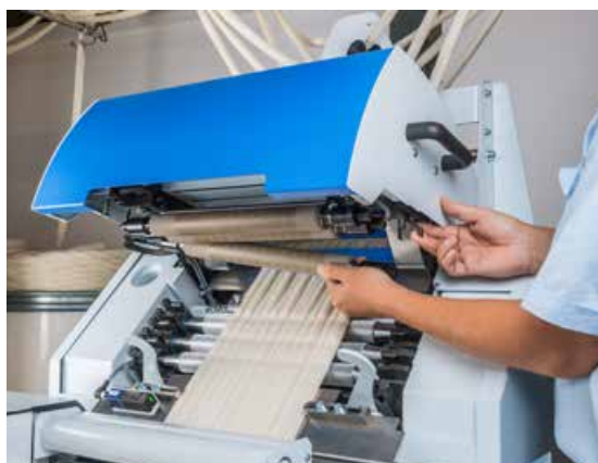
3 接 3 牵伸机构的上罗拉使用上牵伸机构部件折叠,并且可以十分简单的扩大。
