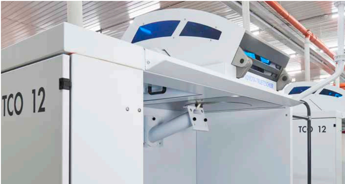
图片中为精梳机 TCO 12 上所安装的用于棉条抽吸装置的吸风支架
