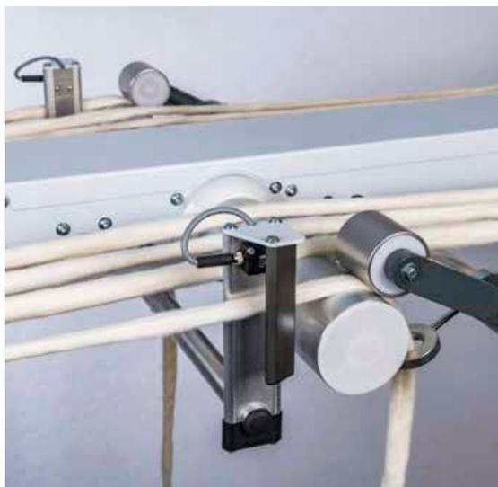
Os pré-passadores da Trützschler também dispõem de sensores SMART para o monitoramento da fita individual.
