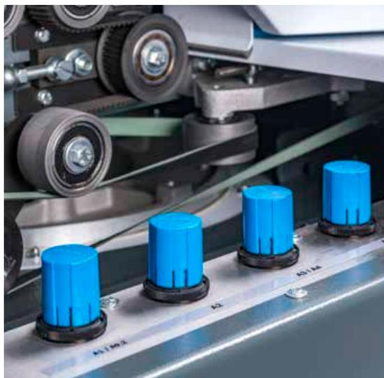
Com esses reguladores, as pressões dos cilindros superiores podem ser ajustadas de forma fácil e reproduzível. Um sensor especial monitora a pressão.
