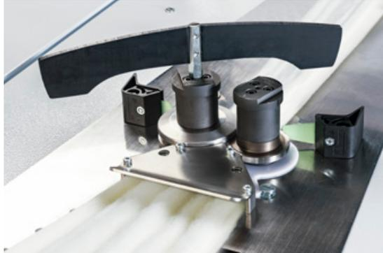
O DISC LEVELLER otimizado, com novo fecho rápido e a tecnologia de acionamento SERVO DRAFT são o coração do passador autorregulado.
