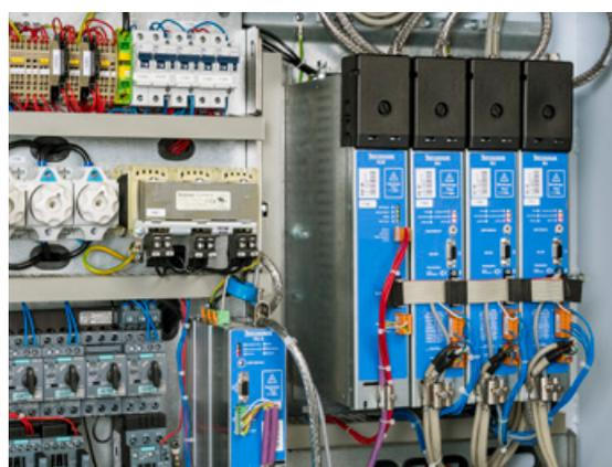
Servoacionamentos digitais acionam diretamente os cilindros do trem de estiragem. Somente mediante a utilização do sistema eletrônico de controle da Trützschler, é possível dispor de soluções personalizadas para a aplicação no campo da fiação.
