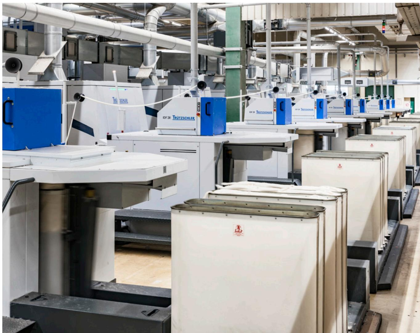
Instalação IDF 2R em uma fiação à rotor
