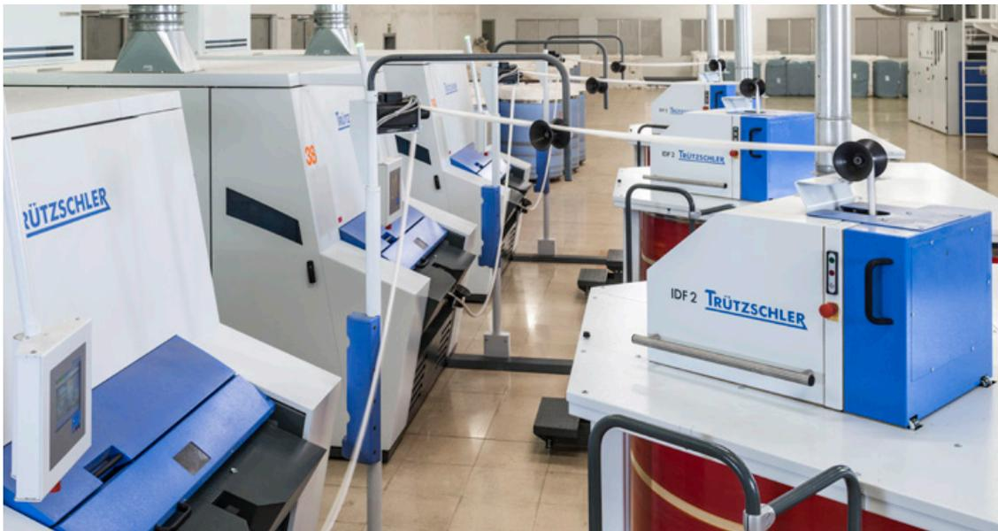
Sincronização totalmente automática da velocidade de entrega com a carda, ajustando o andamento da fita entre a carda e o IDF por meio de fotocélulas
