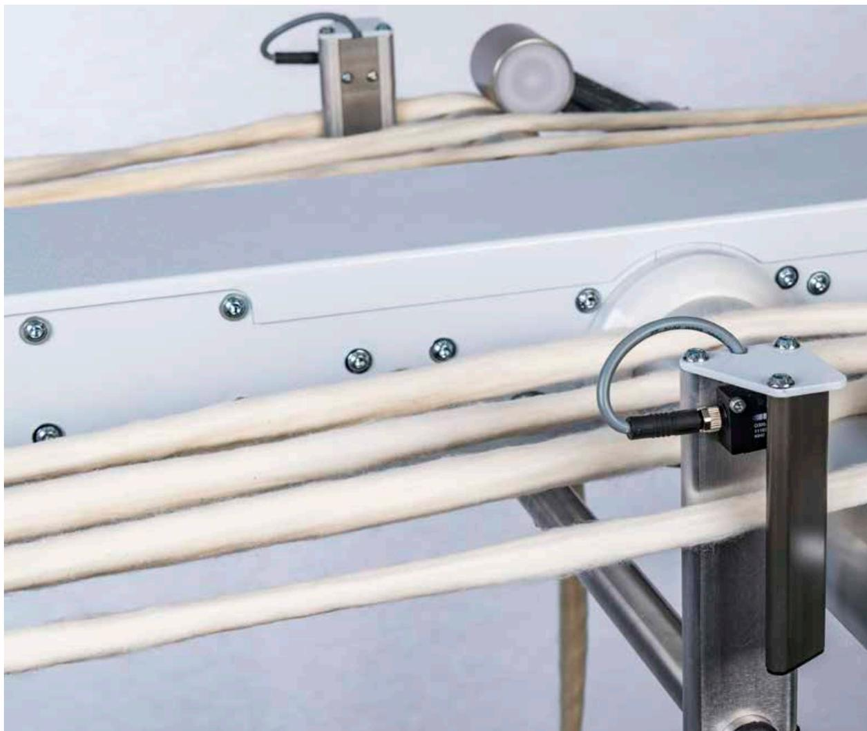
Os novos sensores de fita individual na gaiola detectam de maneira confiável as rupturas de fita, pois pode ser distinguido entre fita parada, sem fita e fita em movimento.
