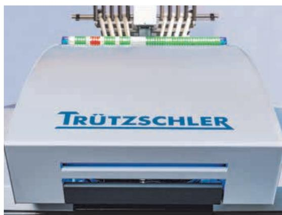
Em conjunto com a nova visualização remota da Trützschler, as rupturas da fita podem ser corrigidas rapidamente e eficazmente. Em caso de uma ruptura da fita, o T-LED comuta automaticamente e exibe a posição da ruptura da fita na gaiola.
