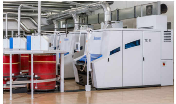
Sıradaki regüleli cer pasajı ile Airjet iplikhanesi için mükemmel: 1.000 mm kovalar ile IDF 2.
