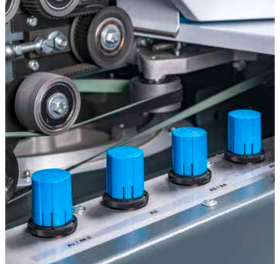
Bu ayarlar ile manşonlarına baskı kolay ve yeniden uyarlanabilir şekilde ayarlanabilir. Özel bir sensör basıncı denetler.
