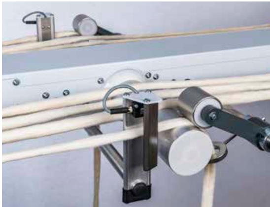
Bireysel şerit gözetimi için SMART sensörleri
