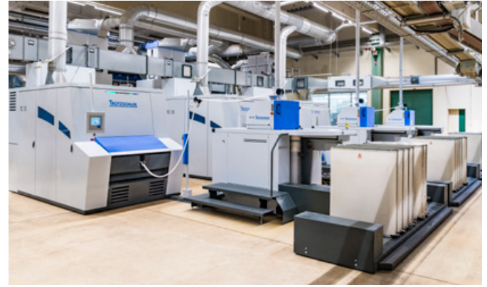
Rotor iplikhanesi için ideal çözüm: Köşeli kova değiştirici ile IDF 2
