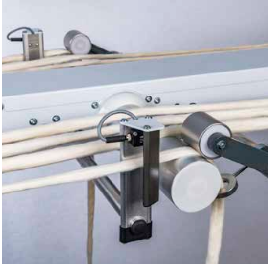
Trützschler'in ön cer makineleri de bireysel şerit gözetimi için SMART sensörlerine sahiptir.
