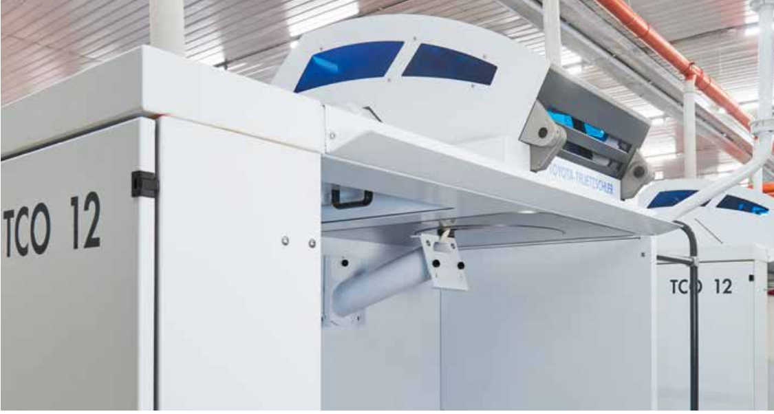
Resimde, TCO 12 penye makinesinde şerit emişi için monte edilmiş emiş başlığı görülmektedir
