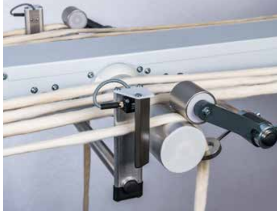
SMART CREEL'de bireysel şerit sensörü
