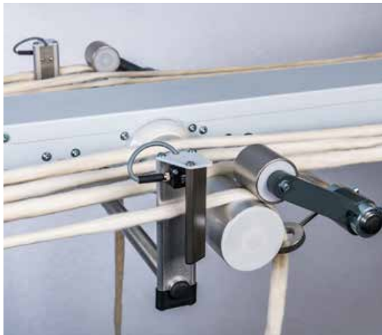
SMART CREEL'de bireysel şerit sensörü
