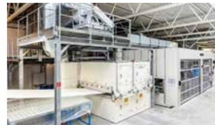
多转鼓烘干机配置热回收系统(HRS)，效率更高
