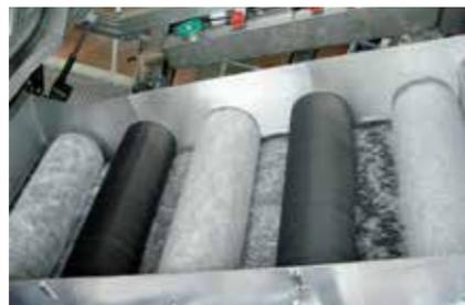
特吕茨施勒非织造的梳理机TWF-NCR以及梳理机TWF-NCA采用一系列相同尺寸的辊子代替小的工作辊和剥取辊。这种配置可以增大梳理区域，但同时纤维的压力较小，因此可以确保棉网质量。
