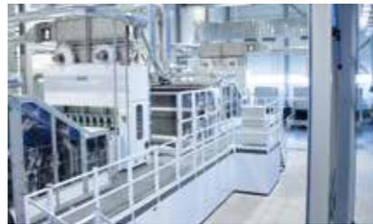
两台梳理机NCR，可用于高性能纯棉非织造生产线
