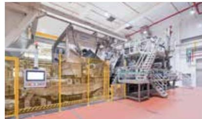
AquaJet水刺机应用于湿法/水刺WLS非织造生产线
