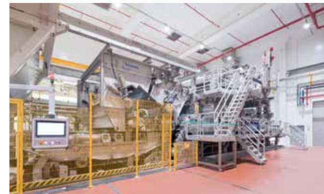
Точно настроенная система: барабан для гидросплетения и струйные головки AquaJet
