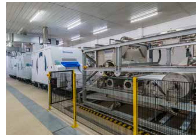
MiniJet спутывает однородное полотно, доставляемое несколькими чесальными машинами TC
