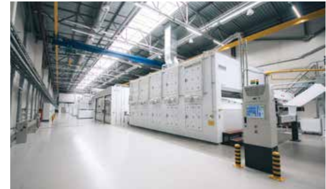
Максимально высокая испарительная способность на небольшом пространстве: 5-барабанная сушилка на линии по производству хлопкового нетканого материала, предназначенной для тяжелого режима эксплуатации
