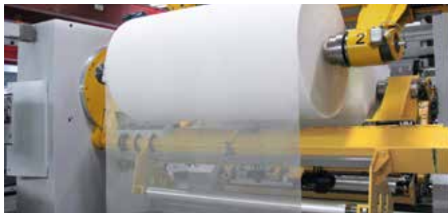
Автоматическое размоточное устройство TWW-UW с порталными рычагами
