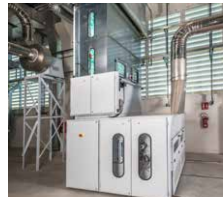
Тонкий рыхлитель TBL-FO для обработки натурального волокна на линиях производства из вискозы
