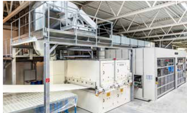
Еще бóльшая энергоэффективность: многобарабанная сушилка с системой рекуперации тепла (HRS)
