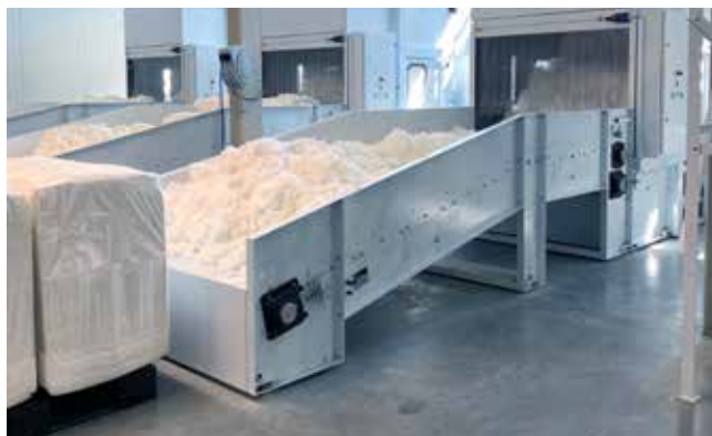
Кипоразрыхлитель TBL-BO настраивается на широкий диапазон волокон
