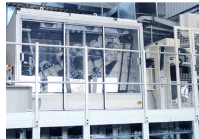
Аэродинамическая чесальная машина NCA по производству полотна со сбалансированным соотношением MD/CD
