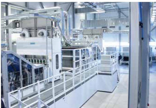
Две рандомизирующие чесальные машины NCR в высокопроизводительной линии производства из хлопка
