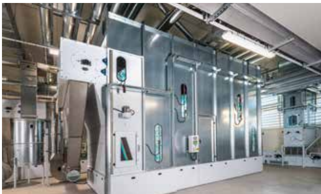
Смесительный бункер TBL-BB: смеситель волокон и накопительная емкость
