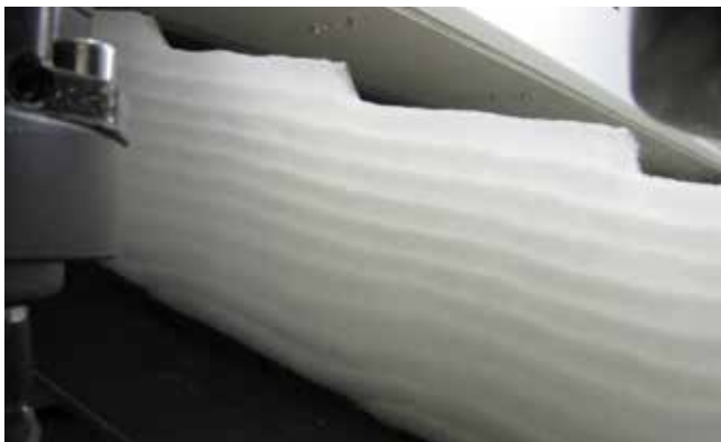
Система CROSSMASTER, которой оснащен преобразователь прочеса, исключает увеличение веса полотна в зоне края
