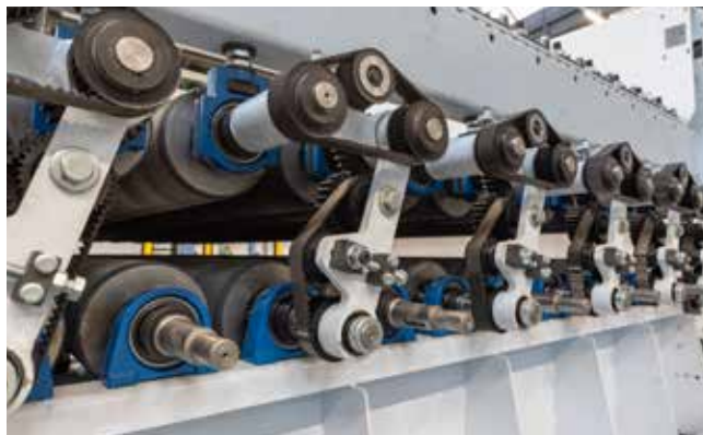
Конечная обработка многослойного полотна: устройство вытяжки полотна TWF-WD
