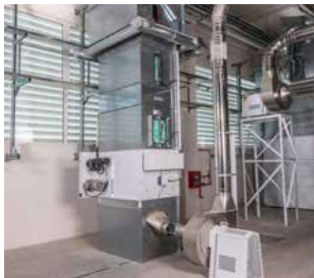
Питающий короб TBL-FB для тонкого рыхления на линиях производства из вискозы
