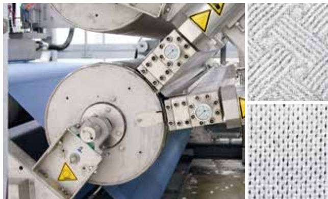
AquaJet на линии влажного формования / гидросплетения (WLS)
