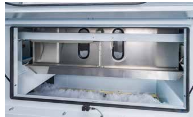
Чашечное взвешивающее устройство TBL-WP обеспечивает высокую точность и производительность
