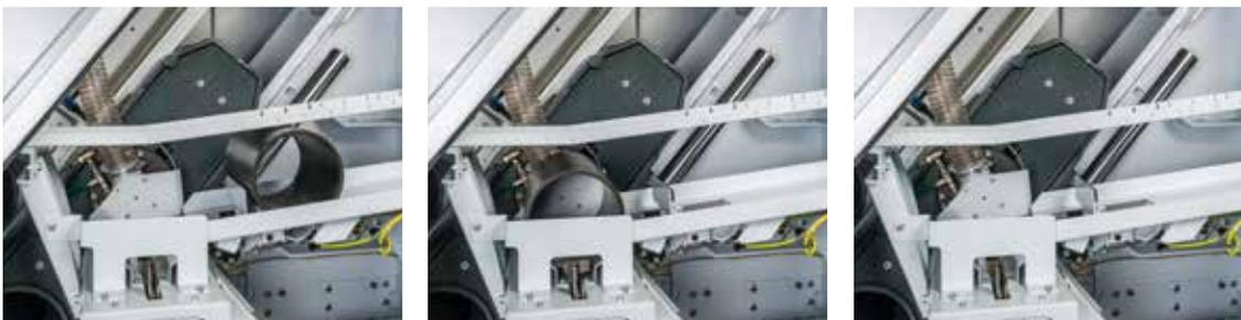
Die leeren Hülsen werden seitlich über eine Öffnung in der Gehäusewand zugeführt. Diese Trützschler-Entwicklung reduziert die erforderliche Zeit für den Wickelwechsel, die den Nutzeffekt maßgeblich beeinflusst.
