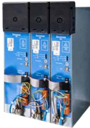
Die kompakte Bauweise des Schaltschranks der TCO 21 mit den Trützschler Antriebsachsen und dem Trützschler Energiemessgerät.
