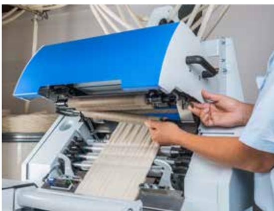
Die Oberwalzen des 3-über-3 Streckwerks werden mit dem oberen Streckwerksteil aufgeklappt und können leicht ausgebaut werden.
