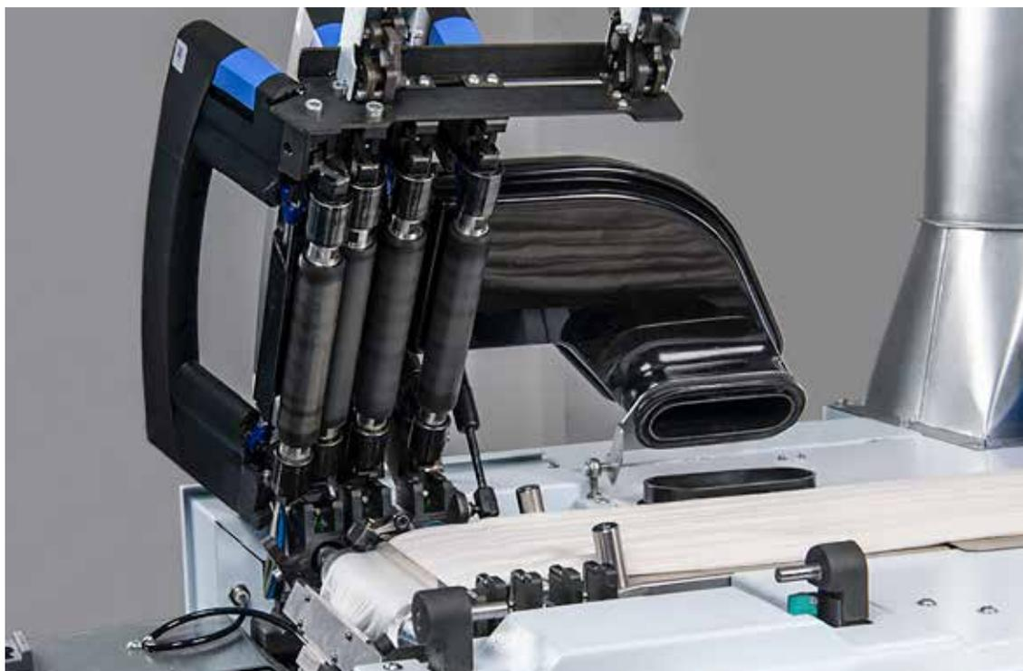
Die Kämmaschine TCO 21 sowie alle Trützschler Streckentypen sind mit dem gleichen bewährten 4-über-3-Streckwerk ausgestattet.
