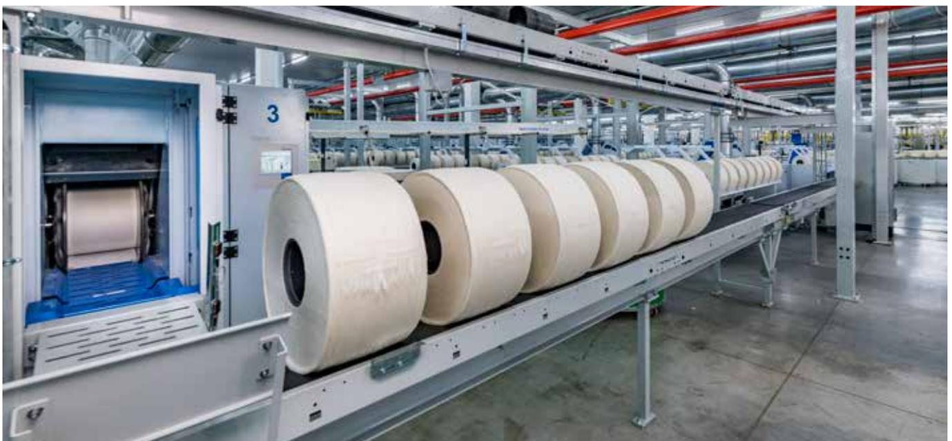
Das Bild zeigt die Transporteinheit für Wickel der Wickeltransport-Automatation (LTS).
