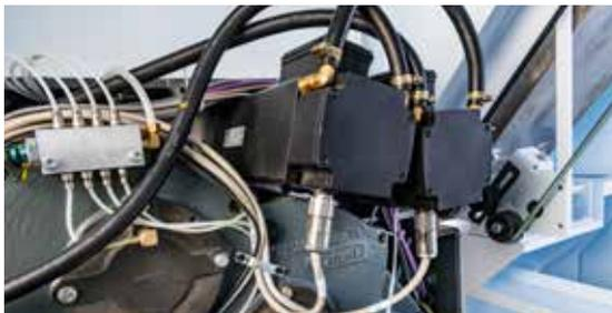
Zwei hochdynamische Servomotoren auf jeder Antriebsseite.
