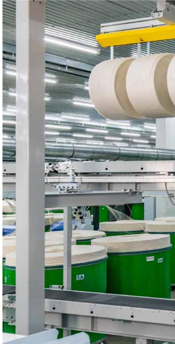
Die Transporteinheit bringt die vollen Wickel von einem Förderband am TSL zu den Kämmaschinen. Dabei werden auch die Leerhüllen abgeholt und wieder zurück gebracht.
