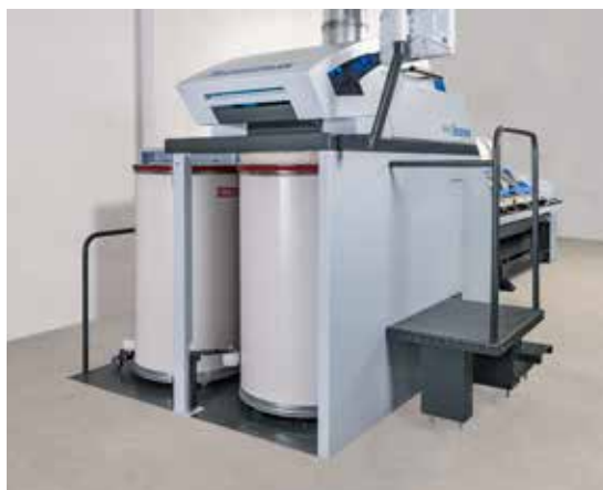
Variante por baixo do piso. Sem rampa. Manuseio mais fácil dos vasos.
