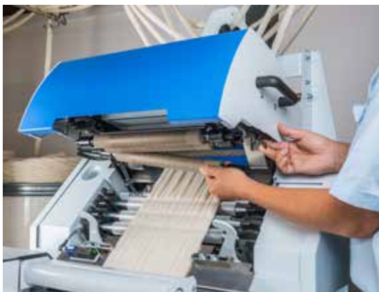
Os cilindros superiores do trem de estiragem 3 sobre 3 são dobrados com a parte superior do trem de estiragem dobrada, e podem ser expandidos facilmente.
