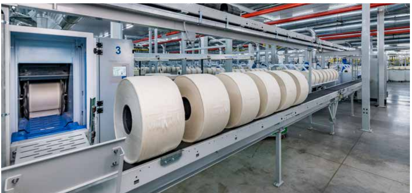
A figura mostra a unidade de transporte para rolos da automação do transporte de rolos (LTS).
