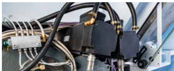
Dois servomotores altamente dinâmicos em cada lado de acionamento.
