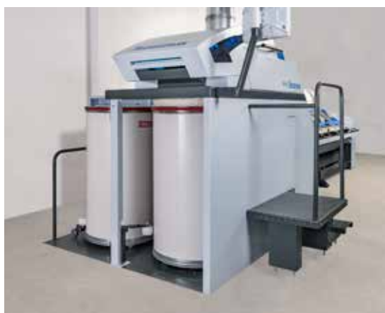
Подпольное исполнение. Отсутствие ramпы. Более простое обращение с тазами.
