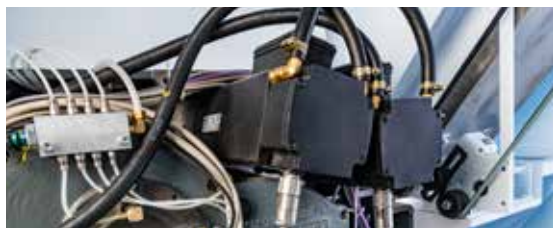
Два высокоскоростных серводвигателя на каждой стороне привода.
