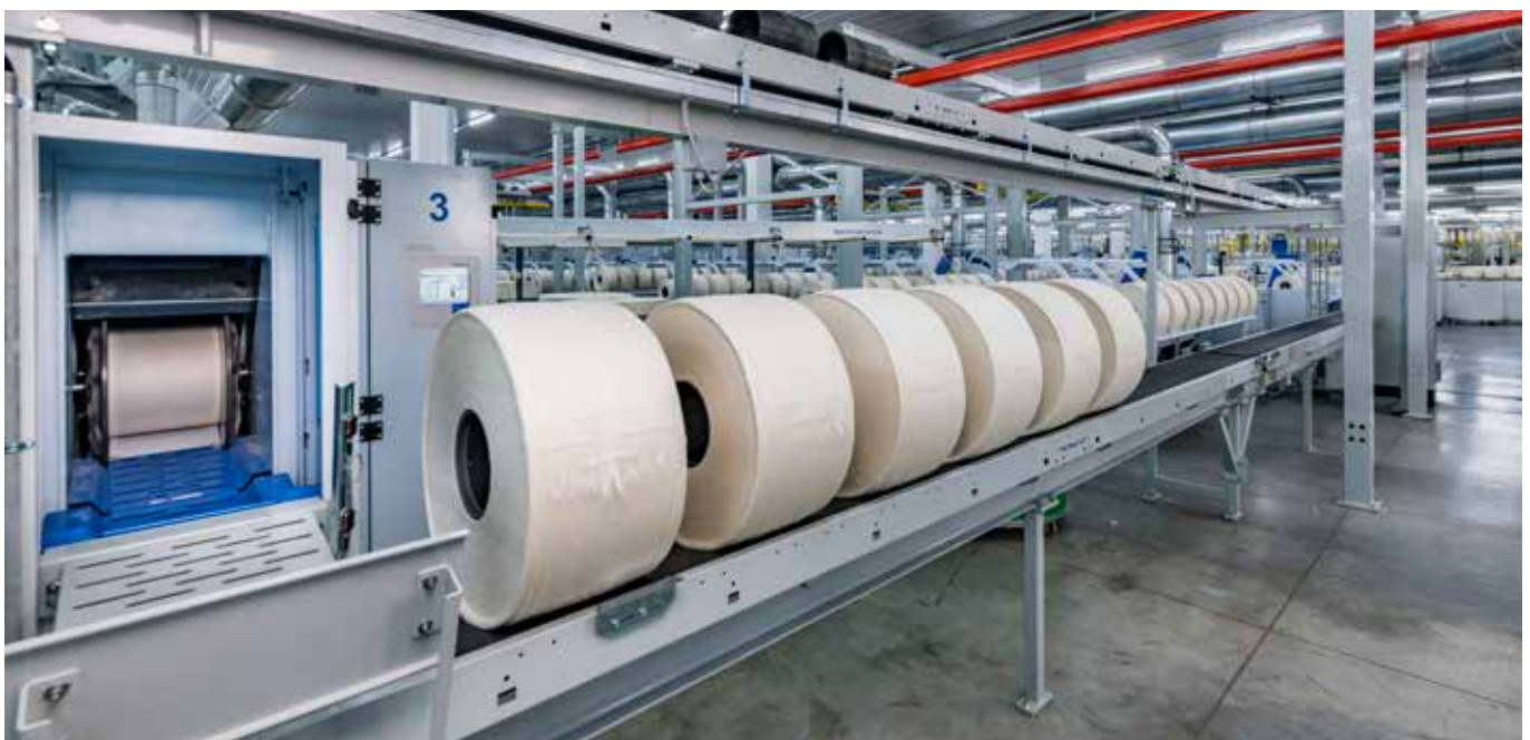
На рисунке показано транспортное устройство для рулонов автоматической системы транспортировки рулонов (LTS).
