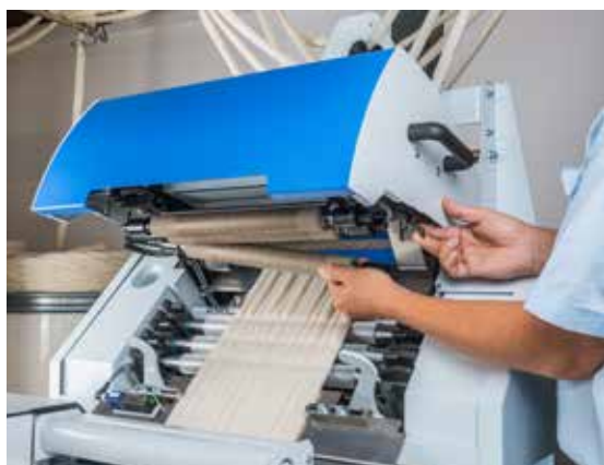
Верхние валики вытяжного прибора с 3 верхними и 3 нижними валиками открываются вместе с верхним вытяжным прибором и могут быть легко демонтированы.
