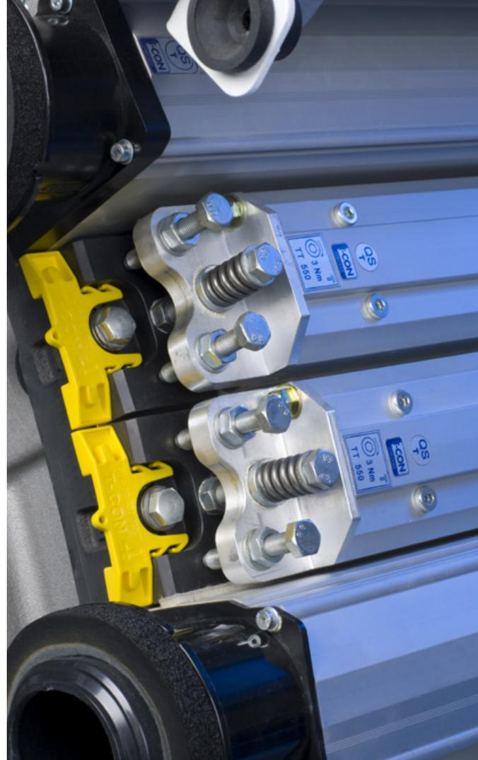
必须根据纤维、生产高度和追求的质量对梳棉条件进行调整。为了能够简单快速地达到目标，-MULTI WEBCLEAN 系统可将锡林预梳区和后梳区中十个特殊元件分别单独连接。其中只有第一个和最后一个元件已被指定，其他 8 个元件均可根据各个应用进行配置。
