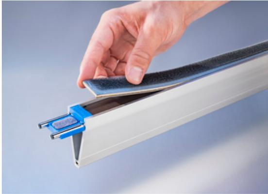
无需费力、无需工具，即可更换针布槽。
