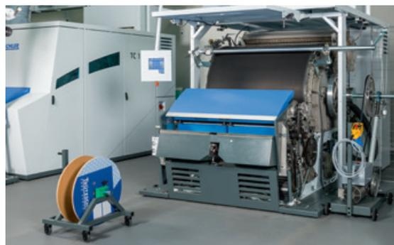
使用全面的牵拉工具 TC-ME, 所有梳棉机可在最大程度上进行装备, 进行修针或者重新包针
