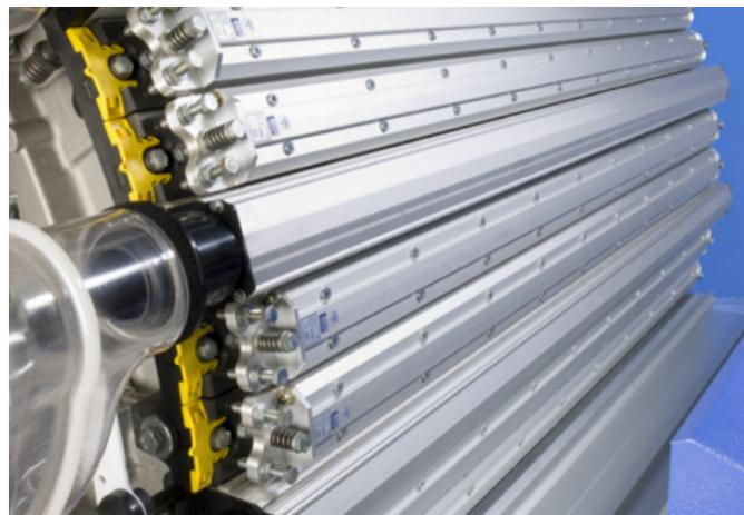
T-CON 3 Spacer 仅需几个步骤即可完成更换, 由此可重复调整分梳板。
