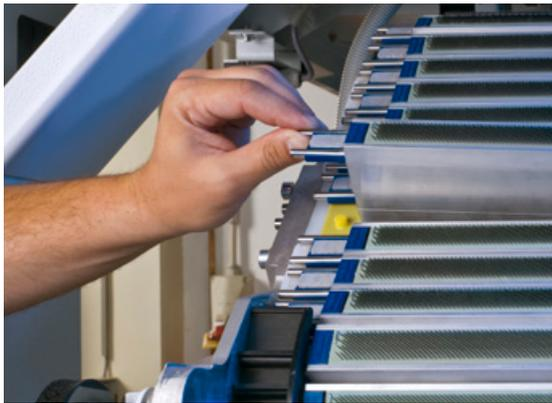
无需工具，盖板条即可轻松插入齿形皮带的凸轮中。
