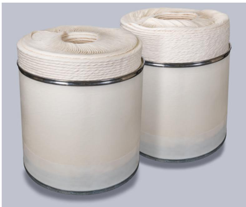
左侧为经过优化的 T-MOVE 2 圈条器形状，右侧为传统的圈条器形状。在两个条桶中可填充 80 kg 生条。
