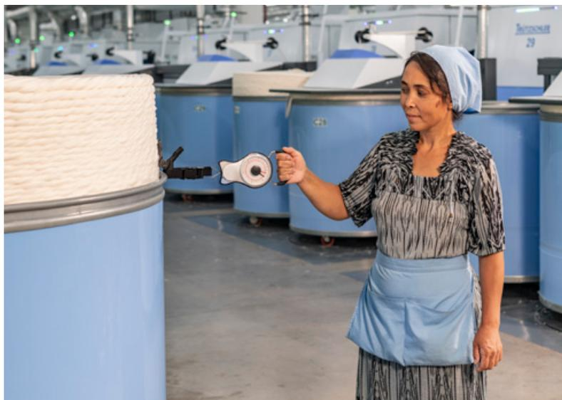
在 JUMBO CAN 中可填充 79 kg 生条。通过火车秤试验表明，移动条桶所需的作用力不高于 6-8kg。
