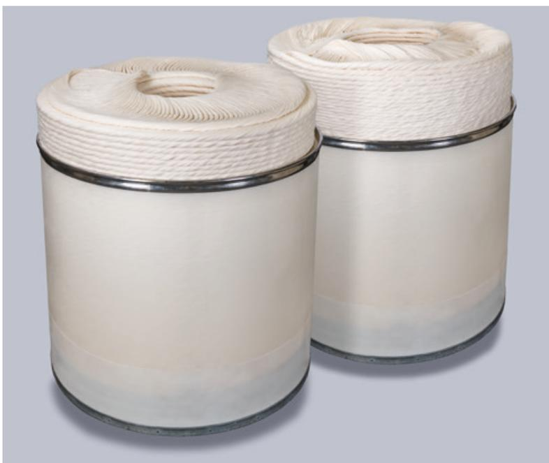
Links die optimierte T-MOVE 2-Ablagegeometrie und rechts die konventionelle Ablagegeometrie. In beiden Kannen befinden sich 80 kg Kardenband.
