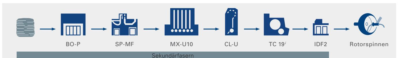
**Legende:** Portal-Ballenöffner BO-P | Multifunktions-Ausscheider SP-MF | Universalmischer MX-U | Universalreiniger CL-U in Edelstahlausführung | Karde TC 19i für Recycling | Integrierte Strecke IDF 2
