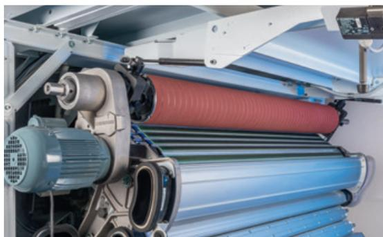
Mit dem Schleifgerät TC-FG werden Deckelgarnituren schnell und einfach aktiviert.
