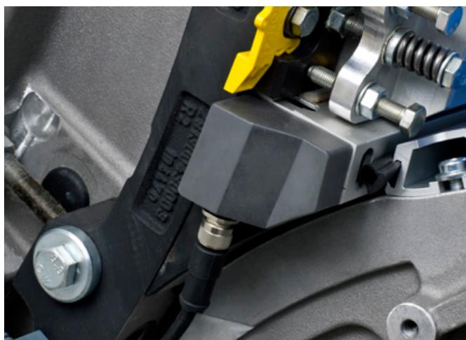
Dieser Sensor misst berührungslos die Trommeltemperatur.
