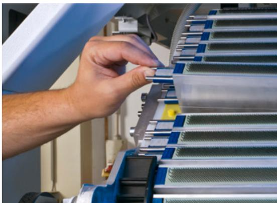
Die Deckelstäbe lassen sich ohne Werkzeug einfach in die Nocken des Zahnriemens einlegen.
