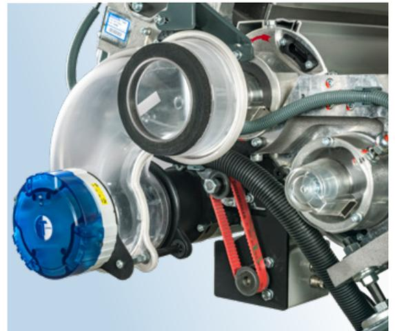
Der blaue Sensor überwacht die Abfallqualität und der Präzisionsmotor verstellt bei Bedarf das Ausscheidemesser.
