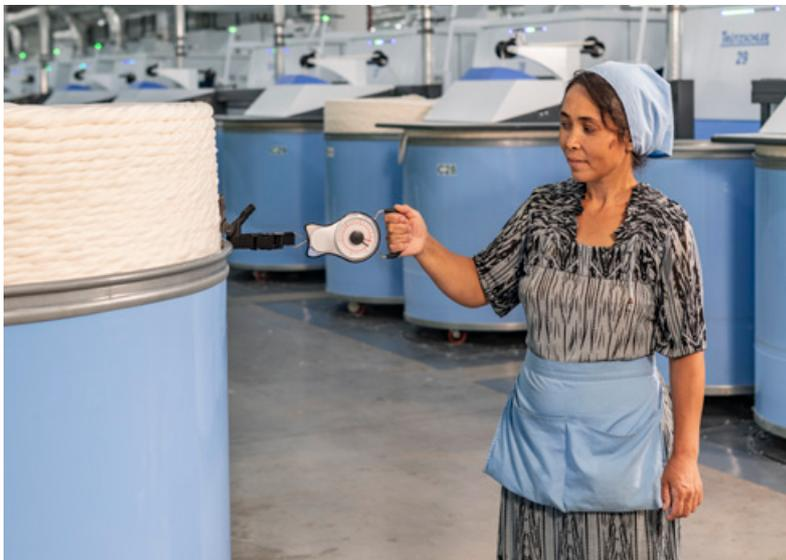
In dieser JUMBO CAN befinden sich 79 kg Kardenband. Der Versuch mit der Zugwaage zeigt, dass nicht mehr als 6-8 kg Kraft nötig sind, um die Kanne zu bewegen.
