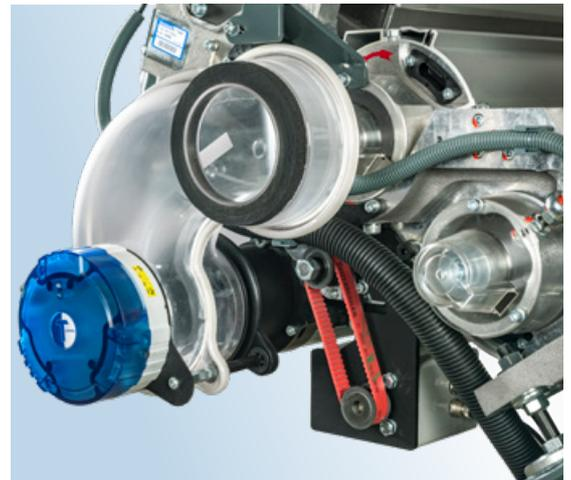
O sensor azul monitora a qualidade dos resíduos e o motor de precisão ajusta a faca, conforme necessário.
