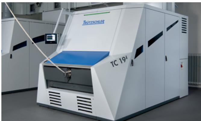
Carda TC 19<sup>i</sup> da Trützschler para fibras sintéticas
