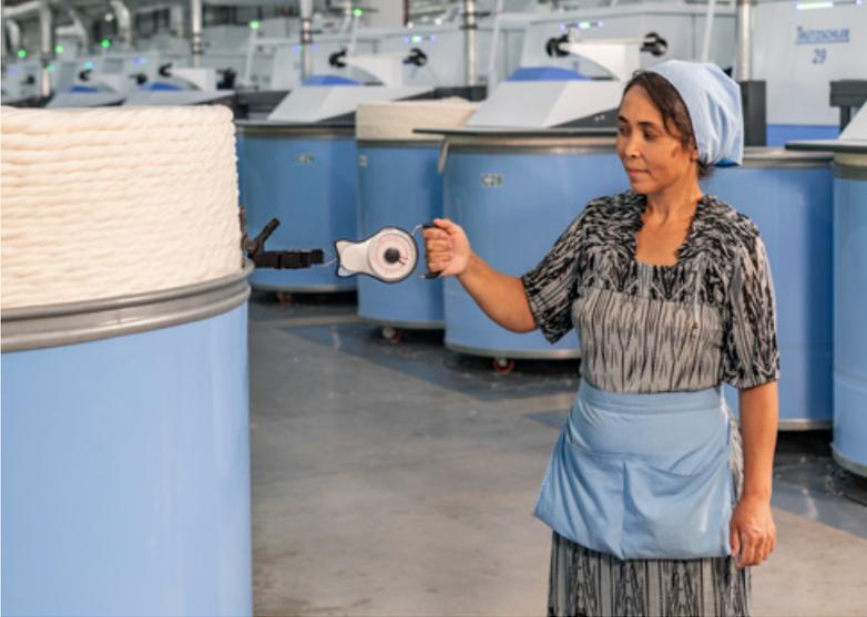
Neste VASO JUMBO encontram-se 79 kg de fita da carda. O ensaio com a balança suspensa mostra que não são necessários mais de 6 a 8 kg de força para deslocar o vaso.
