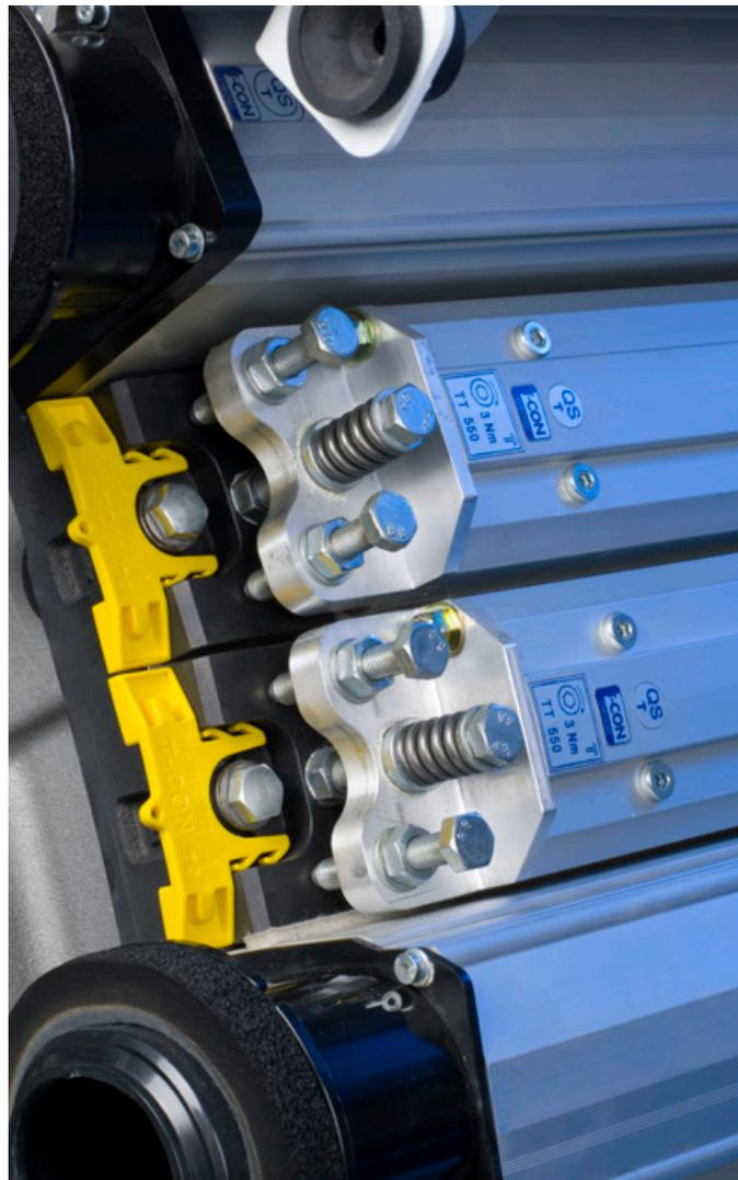
Dependendo das fibras, altura de produção e qualidade desejada, as condições de cardagem têm que ser ajustadas. Para que isso possa ser alcançado fácil e rapidamente, o sistema MULTI WEBCLEAN permite a colocação individual de dez elementos especiais na área de pré-cardagem e de pós-cardagem do tambor. Somente o primeiro e último elemento serão predefinidos, os demais oito elementos podem ser configurados conforme a respectiva aplicação.
