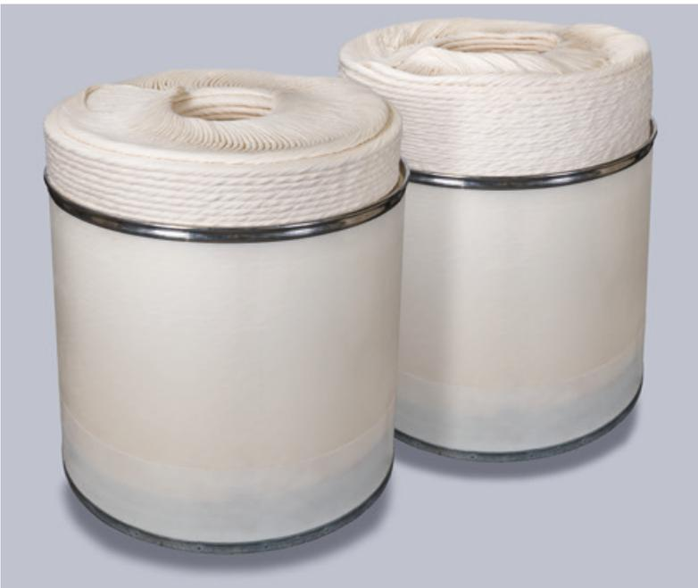
À esquerda, a geometria de deposição T-MOVE 2 otimizada e, à direita, a geometria de deposição tradicional. Em ambos os vasos encontram-se 80 kg de fita da carda.
