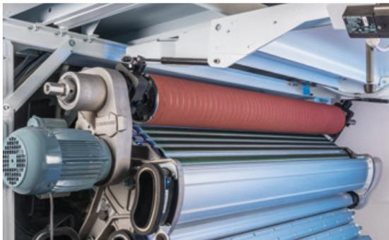
Com o amolador TC-FG, as guarnições dos flats são ativados de forma rápida e simples.
