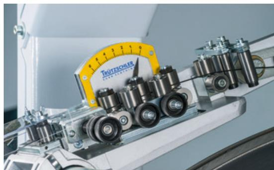
O braço de montagem T-Winder permite levantar uniformemente todos os modelos e espessuras de guarnições.
