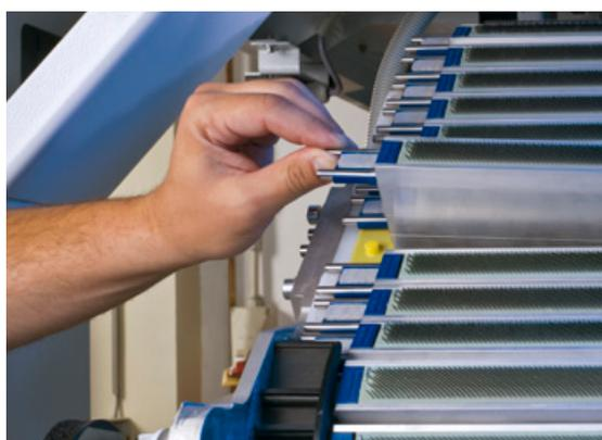
As barras dos flats são facilmente inseridas no cames da correia dentada sem ferramentas.
