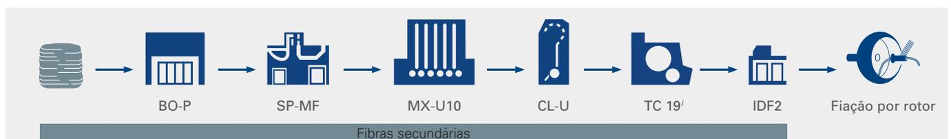
**Legenda:** Abridor de fardos de portal BO-P | Separador multifunções SP-MF | Misturador universal MX-U | Limpador universal CL-U e versão em aço inox | Carda TC 19i para reciclagem | Passador integrado IDF 2
