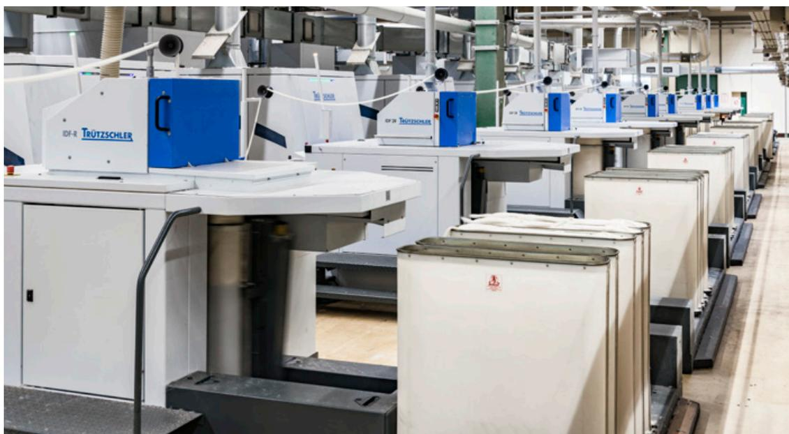
Instalação IDF 2R em uma fiação à rotor
