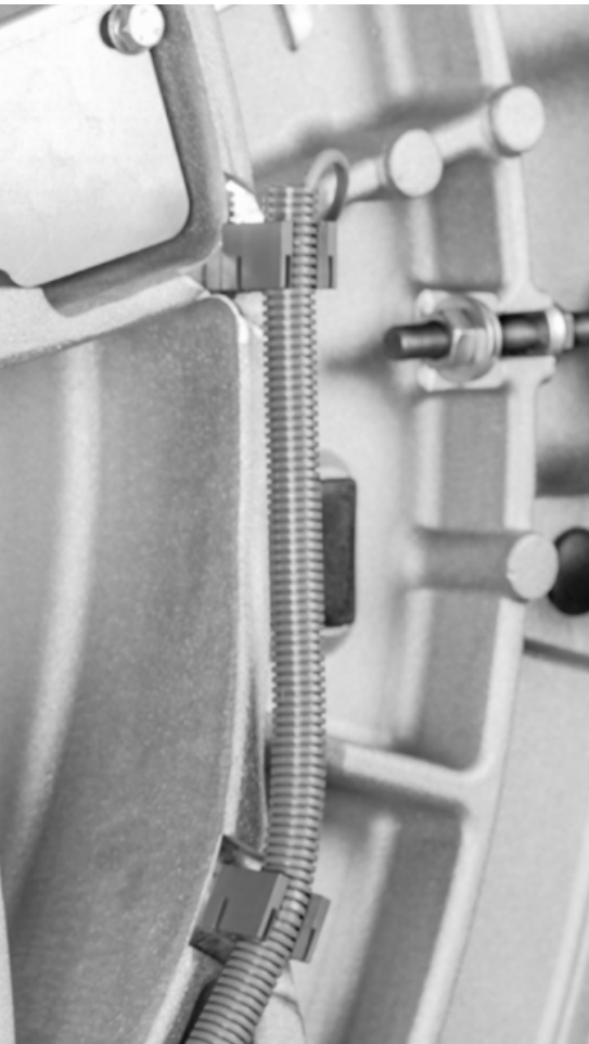
Bu sensör temas etmeden tambur sıcaklığını ölçer.
