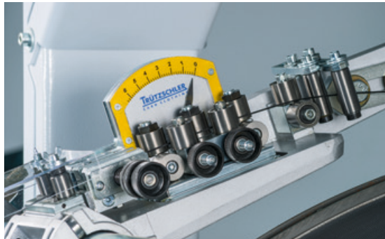
T-Winder sarım kolu tüm garnitür modellerinin ve garnitür kalınlıklarının düzgün bir şekilde sarılmasını sağlar.
