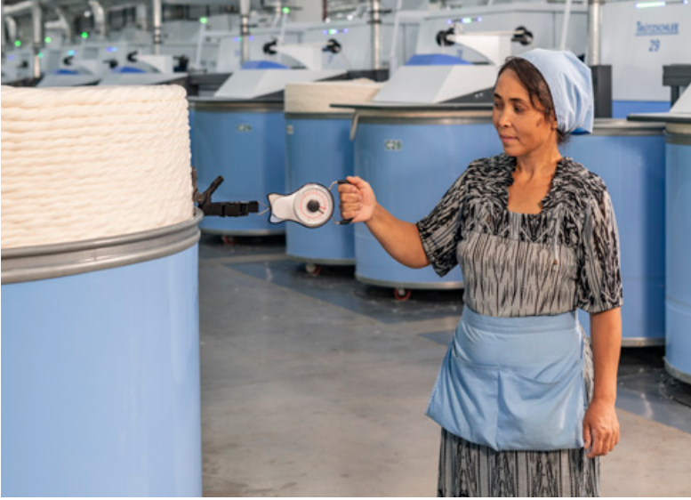
JUMBO CAN içinde 79 kg tarak şeridi bulunmaktadır. Terazi ile yapılan test, kovayı hareket ettirmek için 6-8 kg'dan daha fazla kuvvet gerekmediğini göstermektedir.
