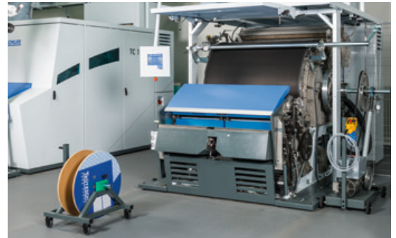
Trützschler'in kapsamlı garnitür sarım cihazı TC-ME ile bütün tarak makineleri garnitür sarma ve sökme işlemleri için en iyi şekilde donatılmıştır.
