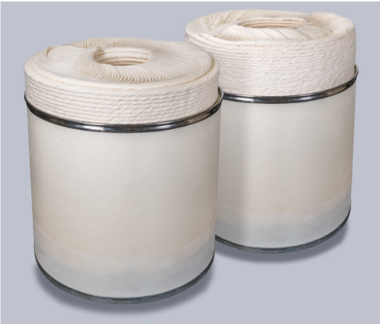
Solda optimize edilmiş T-MOVE 2 istifleme geometrisi ve sağda geleneksel istifleme geometrisi. Her iki kovada da 80 kg tarak şeridi bulunmaktadır.
