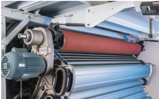
Bileme cihazı TC-FG ile şapka garnitürleri hızlı ve hızlı ve kolay bir şekilde aktif edilir.
