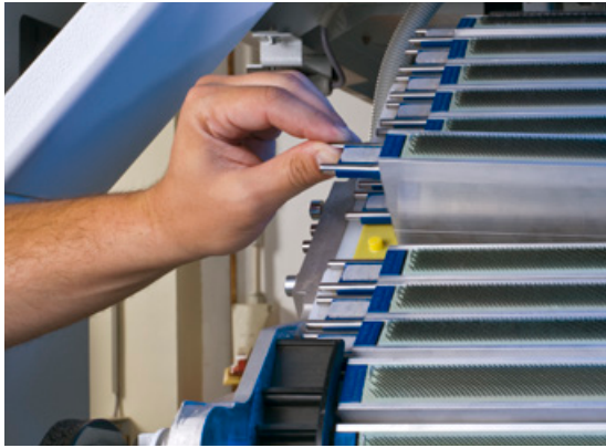
Şapka çubukları, dişli kayışın kamlarına alet kullanmadan kolayca takılabilir.
