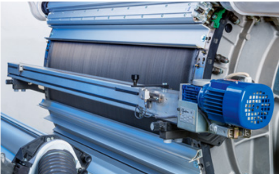
Çapraz hareket eden bileme cihazı TC-GD, tambur ve dofer için en iyi tarama sonuçlarını sağlar.
