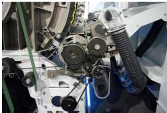
梳棉机TC 10配置单刺辊WEBFEED时的棉网喂入装置
