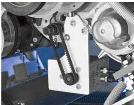
小型伺服电机对除尘刀进行围绕WEBFEED的第一刺辊中心的圆周调节
