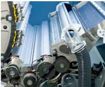
一体化感应喂棉装置SENSOFEED+, 完美的握持, 精确的短片段自调匀整
