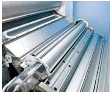
完全一体化的棉簇喂棉装置DIRECTFEED, 内置了风量分离器以及分段式喂棉装置
