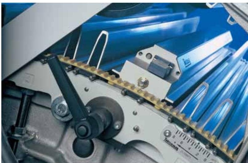
梳棉机上的精确盖板检测装置FLATCONTROL
