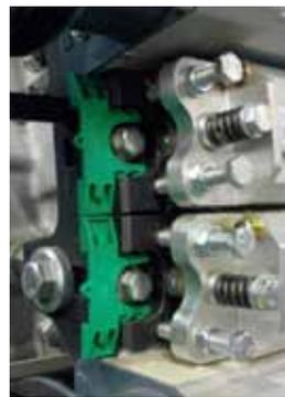
T-Con隔距片不仅更换迅速，还保证了梳理元件隔距设定的可再现性
