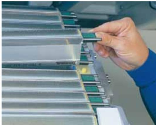
无需任何工具，即可简便地将盖板固定在凸齿带的凸齿上
