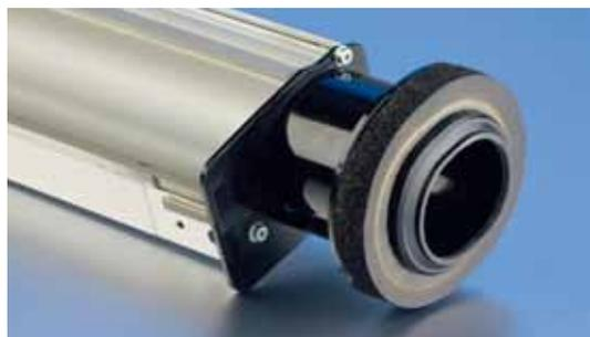
此元件包括一个持续吸风作用下的除尘刀和吸风罩。它可以控制锡林的气流状况，将抛起的灰尘和杂质吸走。
