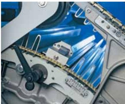
“特吕茨勒独有”活动盖板隔距精确测量装置-FLATCONTROL系统
