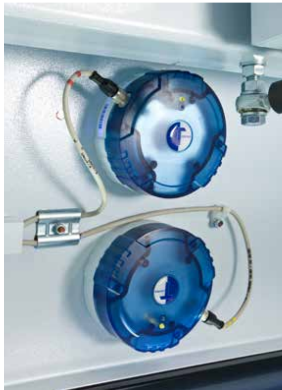
特吕茨施勒速度传感器可最大限度地减少压缩空气需求和纤维损失。
