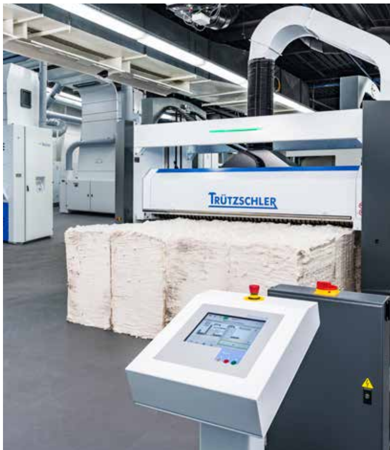
门架式抓包机BO-P的操作终端显示重要的信息数据
