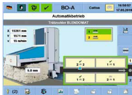
BO-A抓包机的控制器显示示例
