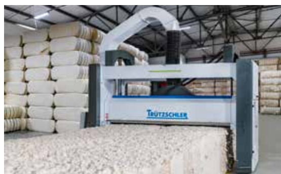
加工紧压的废棉棉包。即使产量达到2,400kg/h，亦无沟槽出现，棉包外观平整。
