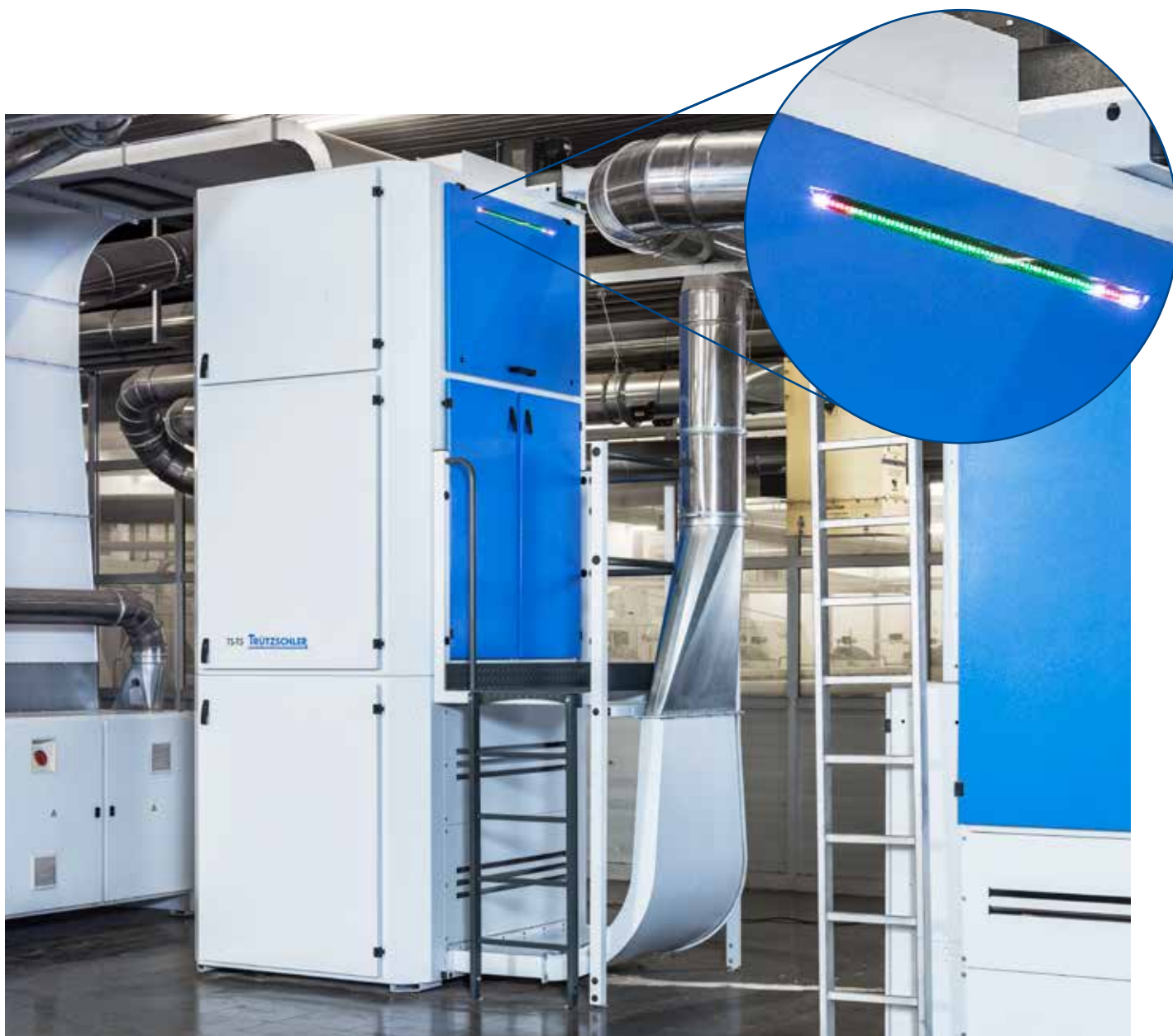
远程指示器T-LED可远程显示机器状况。
