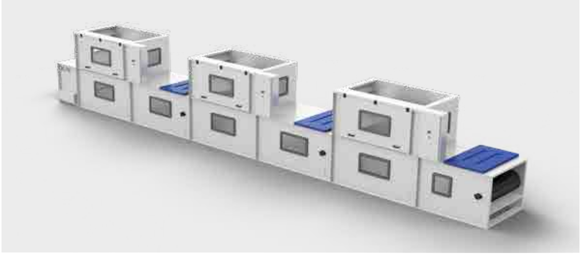
Elyaf karıştırma bandı BL-TC modüler olarak kurulmuştur. 2 ile 6 arasında tartı birimi beslemesi gerçekleştirilebilir.
