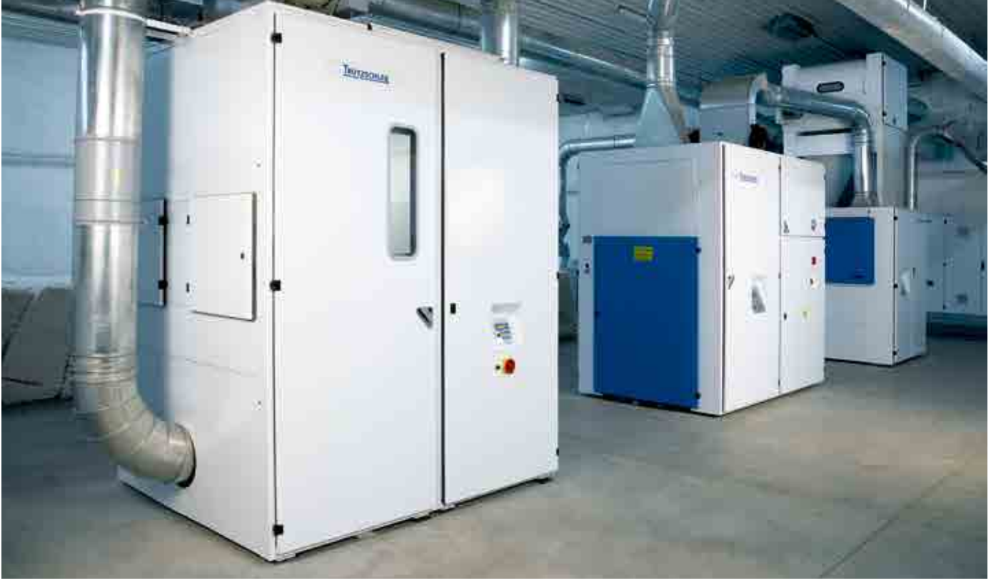
Toz ayırma makinesi DUSTEX, elektronik metal ayırıcı SP-EM ve ön temizleyici CL-P
