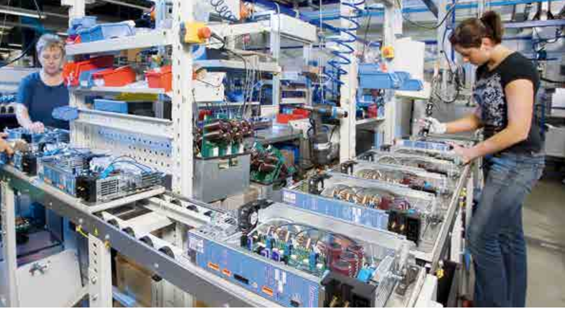
Dijital kumandaların Trützschler'in Mönchengladbach, Almanya'da bulunan ana fabrikasında montajı
