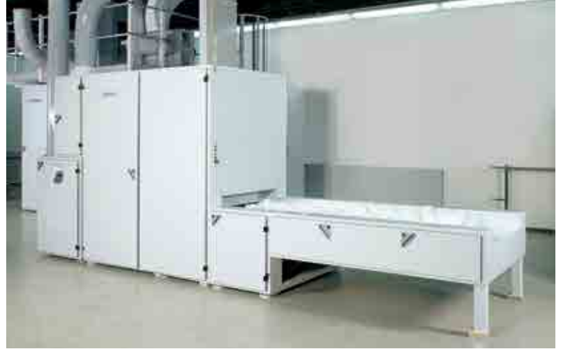
<300 kg/h üretimler için üniversal balya açıcı BO-C
