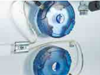
Yabancı parça ayırıcılarında Speed sensörleri yabancı maddelerin hızını tespit eder ve minimum lif kaybında hassas bir ayırmayı mümkün kılar. Sayfa 34
