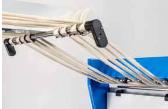
O TD 7 tem um monitoramento de fita única na entrada do passador.
