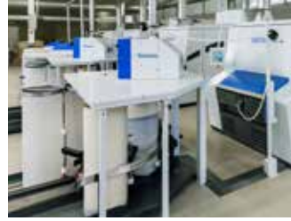
Passador integrado IDF 2 para frações de rotor. Página 26
