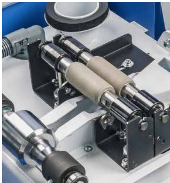
Os cilindros superiores (a bege) podem ser rodados 180° depois de gasto o revestimento dos cilindros superiores (desgaste a vermelho)
