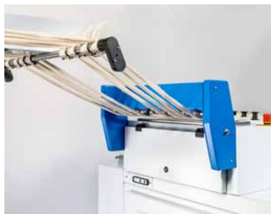
Monitoramento de fita na entrada do passador
