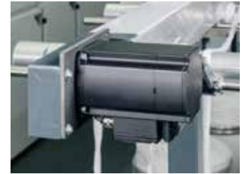
A gaiola SERVO CREEL contribui para uma regulagem dinâmica graças ao seu acionamento individual. Página 38
