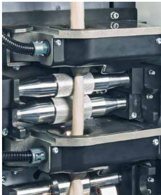
Sensor para detecção do título da fita (acima) e sensor de qualidade (abaixo)
