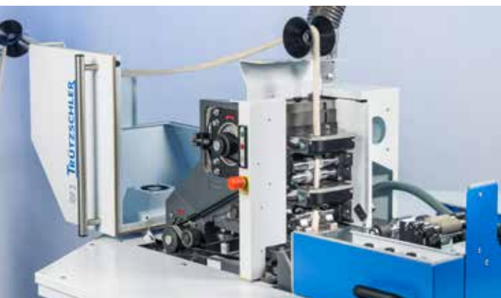
Trem de estiragem e motores são fácil e rapidamente acessíveis.
