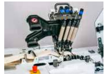
A abertura e fecho do trem de estiragem com apenas uma mão revelam sua orientação prática eficaz. Os cilindros superiores permanecem presos nos suportes dos cilindros superiores. Página 10
