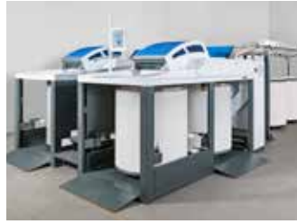
O novo passador de 1.ª passagem TD 9T foi desenvolvido também para o novo formato de JUMBO CANS de 1200 mm. Página 12
