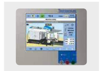
O display do passador autorregulador pode ser girado e é instalado na área de trabalho direta do operador. Página 40
