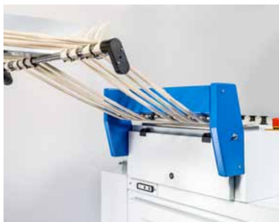
Устройство контроля отдельных лент на входе ленточной машины
