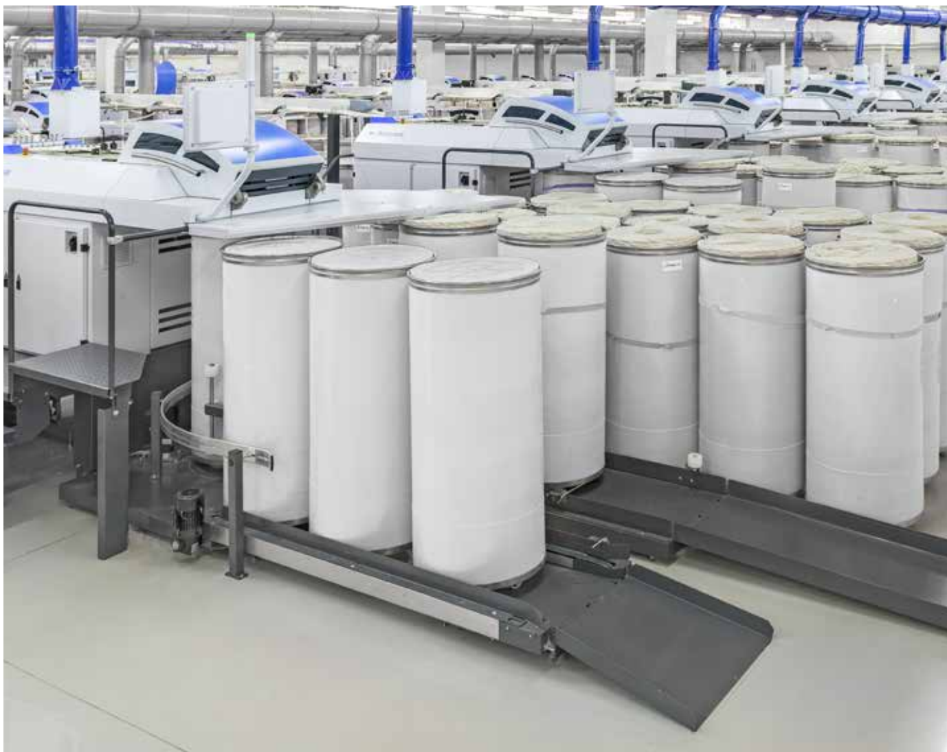
Автоматический тазовый сменщик для ленточных машин TD 7 и TD 8, а также IDF 2 (в данном случае напольное исполнение)
