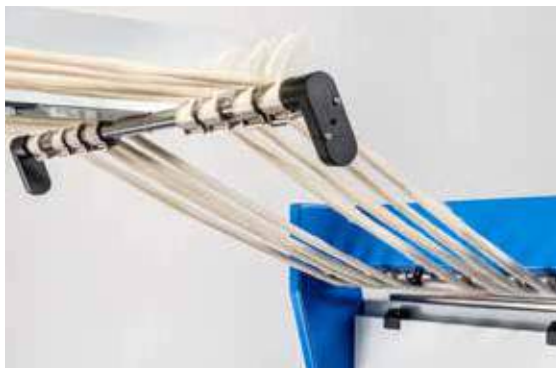
Ленточная машина TD 7 имеет устройство контроля отдельных лент на входе.
