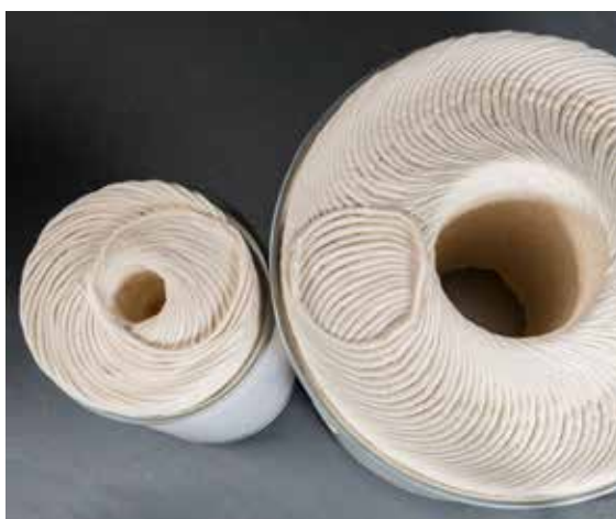
Простая настройка благодаря отдельному приводу для тазового сменщика позволяет идеально настраивать геометрию укладки ленты.
