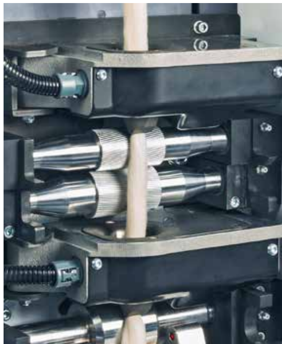
Сенсор для определения толщины ленты (вверху) и сенсор качества (внизу)
