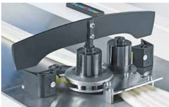
Блок валика с пазом и контактного валика DISC LEVELLER
