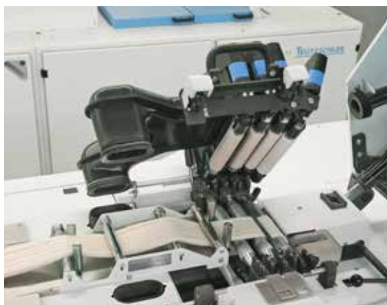
Технология вытяжного аппарата с 4 верхними и 3 нижними валиками
