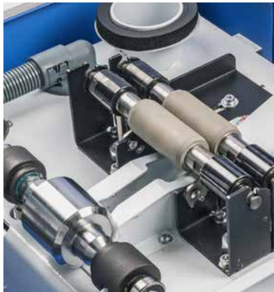
После износа покрытий верхних валиков (износ отмечен красным) верхние валики (бежевые) можно просто повернуть на 180°.
