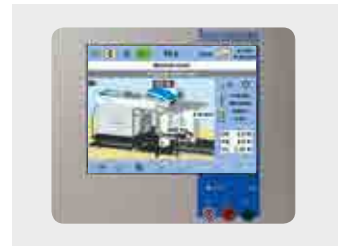
Regüleri cerinin ekranı döndürülebilir şekilde tasarlanmıştır ve operatörün çalışma alanına yerleştirilmiştir. Sayfa 40
