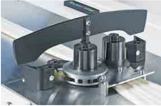
Oluk ve yoklama silindiri ünitesi DISC LEVELER
