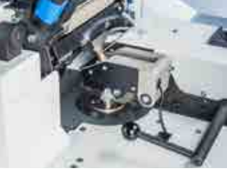
Kalite sensörü DISC MONITOR, güvenilir bir şekilde kalite verilerini hesaplar. Sayfa 41
