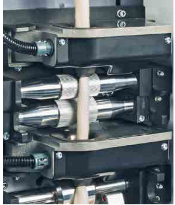
Şerit numarasını (üst) hesaplayan sensör ve kalite sensörü (alt)
