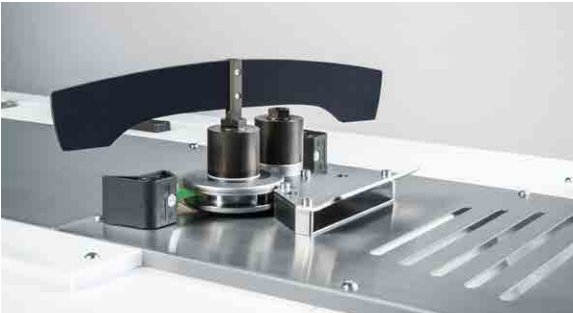
Oluk ve yoklama silindiri ünitesi DISC LEVELER
