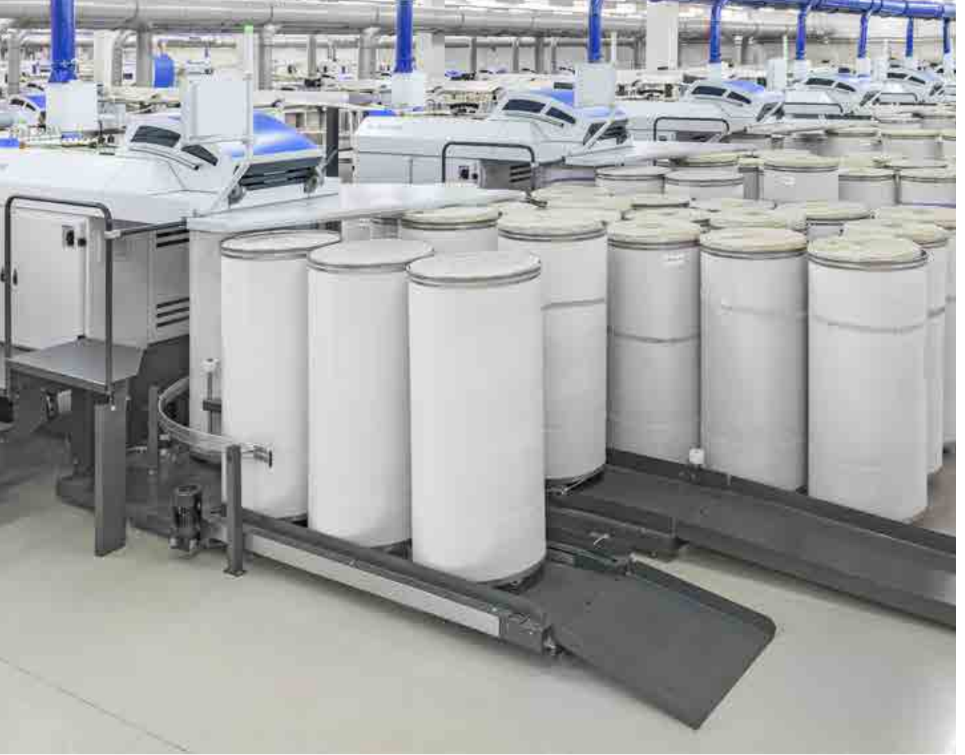
TD 7 ve TD 8 ve ayrıca IDF 2 cerleri iin otomatik kova deęiřtirici (burada bir zemin st versiyonu grlr)
