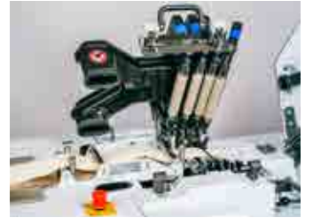
Etkili uygulama yönelimi, çekim ünitesinin tek elle açılmasını ve kapatılmasını gösterir. Üst silindirler emniyetli bir şekilde tutularak üst silindir taşıyıcılarında kalır. Sayfa 10
