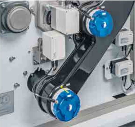
Döküntü sensörü WASTECONTROL döküntü kalitesini ölçer.
