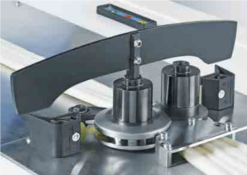
DISC LEVELLER cerde ayarlama için gerçek değerleri tespit eder ve dolaylı olarak önceki makinelerin bantlarını da kontrol eder.
