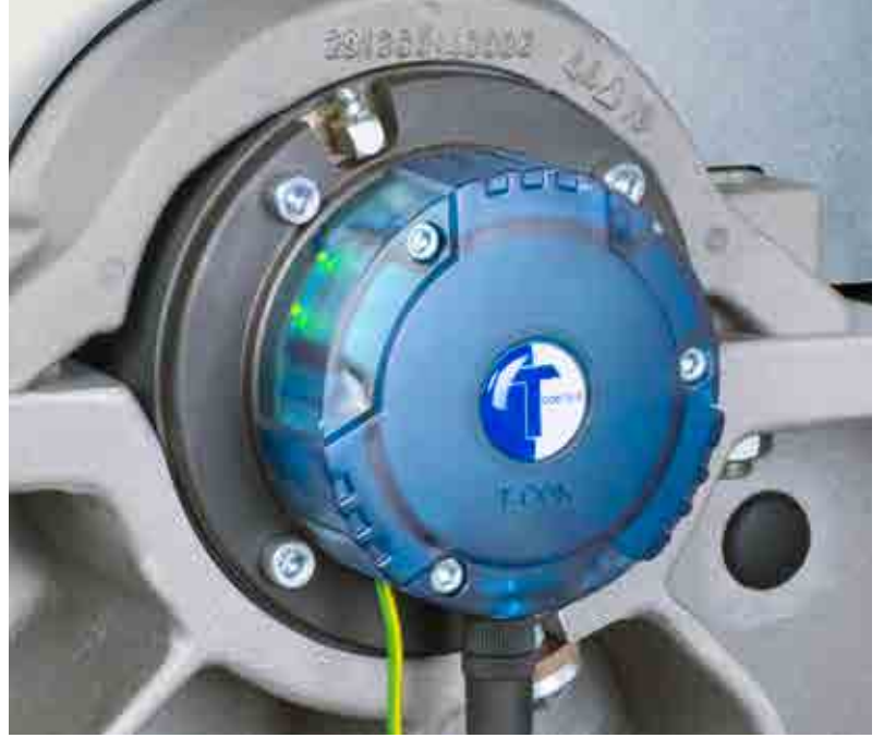
Bu sensör tarama elemanları arasında temasları tespit eder.
